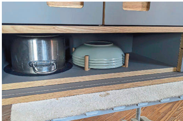
/ Sicherer Transport: Speziell geformte Einsätze hinter dem horizontal laufenden Rollladen nehmen Teller und Töpfe auf und fixieren diese während der Fahrt
